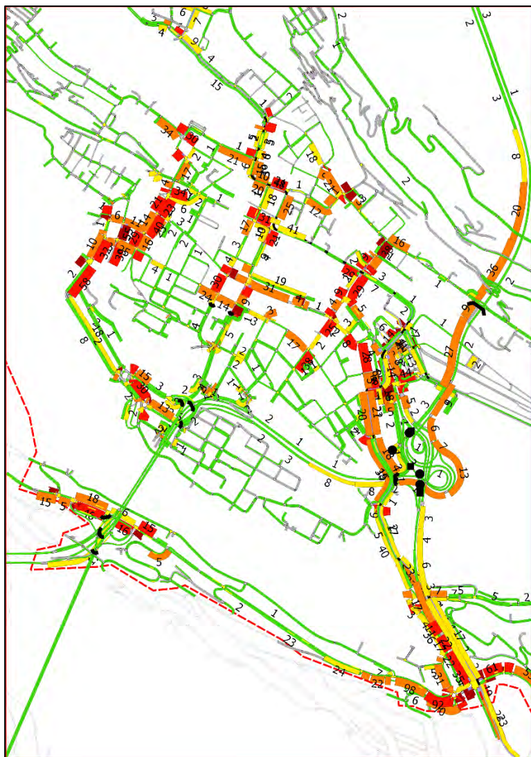
Figur 128 Maks gjennomsnittlig forsinkelse (s) per kvarter per lenke for alt2 variant b med reguleringsplan for Torborg Nedreaas gate.
