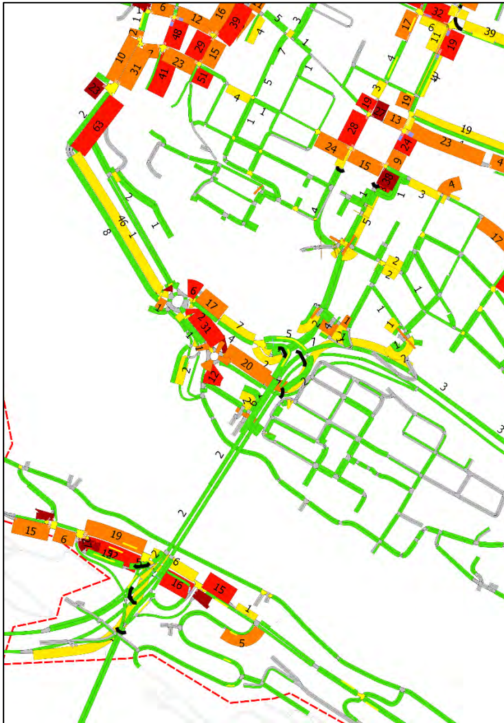
Figur 125 Maks gjennomsnittlig forsinkelse (s) per kvarter per lenke etter at tvungen høyresving i Nøstegaten fra Hurtigrutekaaien er innført
