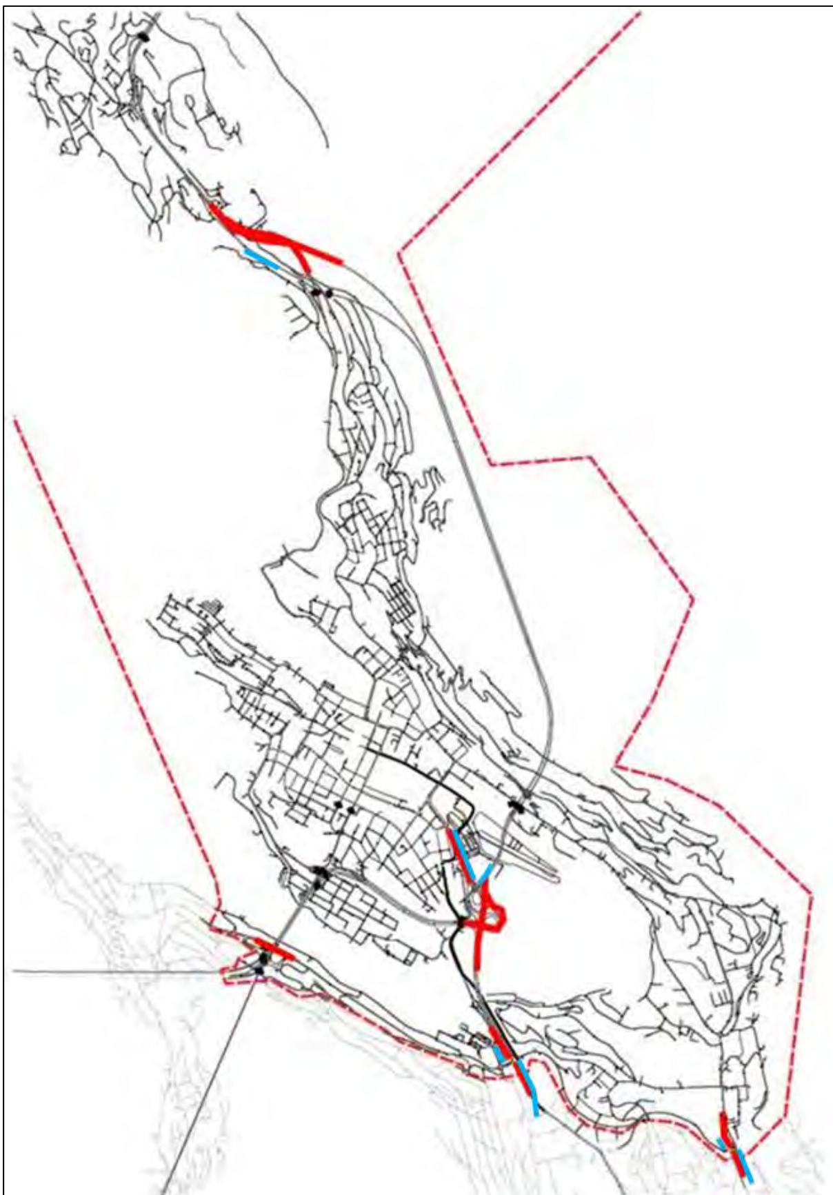
Figur 7: Figuren viser hvor det erfaringsmessig oppstår kø i dagens situasjon i modellområdet med blått for morgenerush og rødt for ettermiddagsrush.
