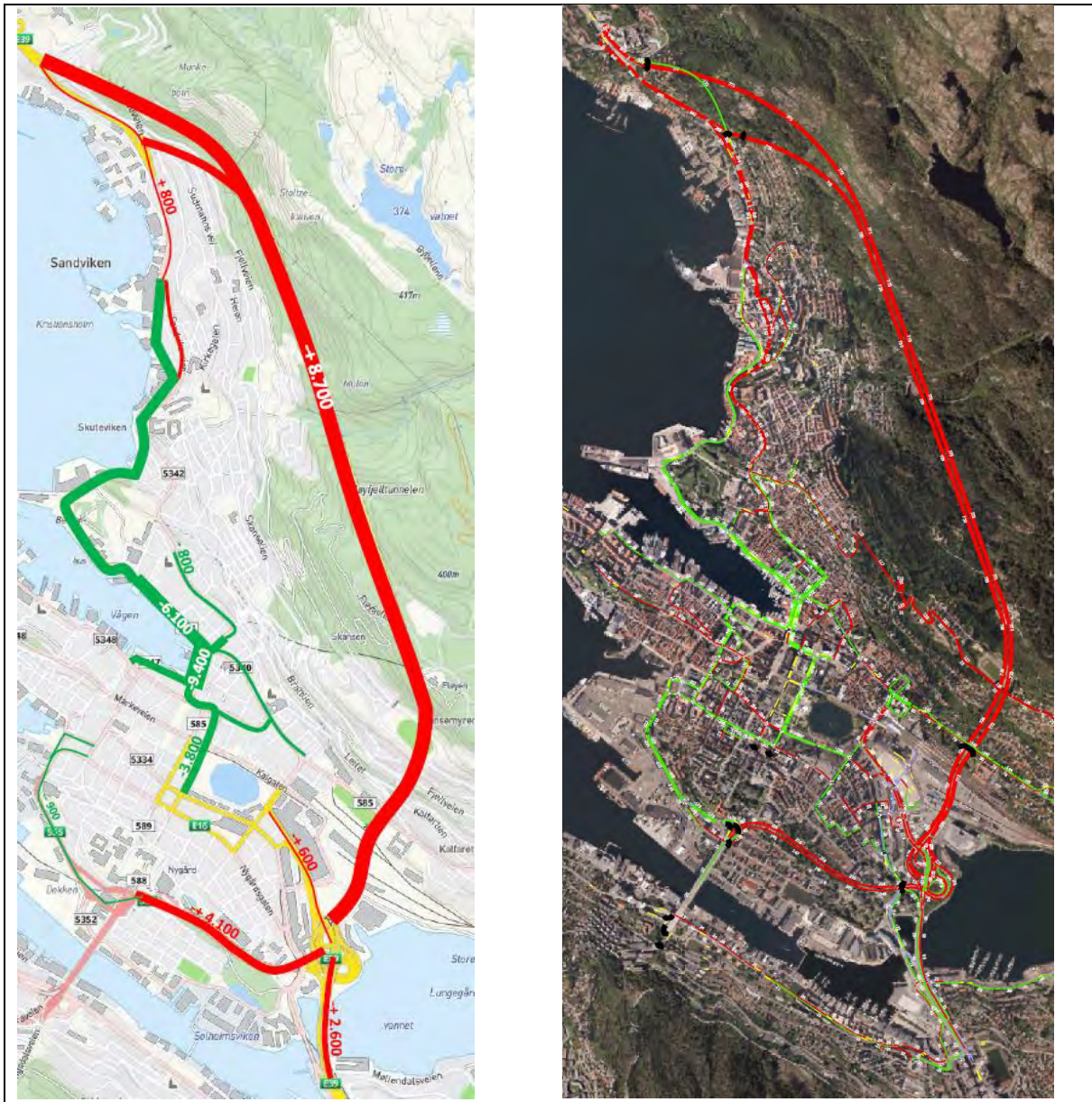
Figur 48: Differanseplot med faktiske endringer i ÅDT til venstre og simulerte endringer i ettermiddagsrush i 2 timer til høyre.
