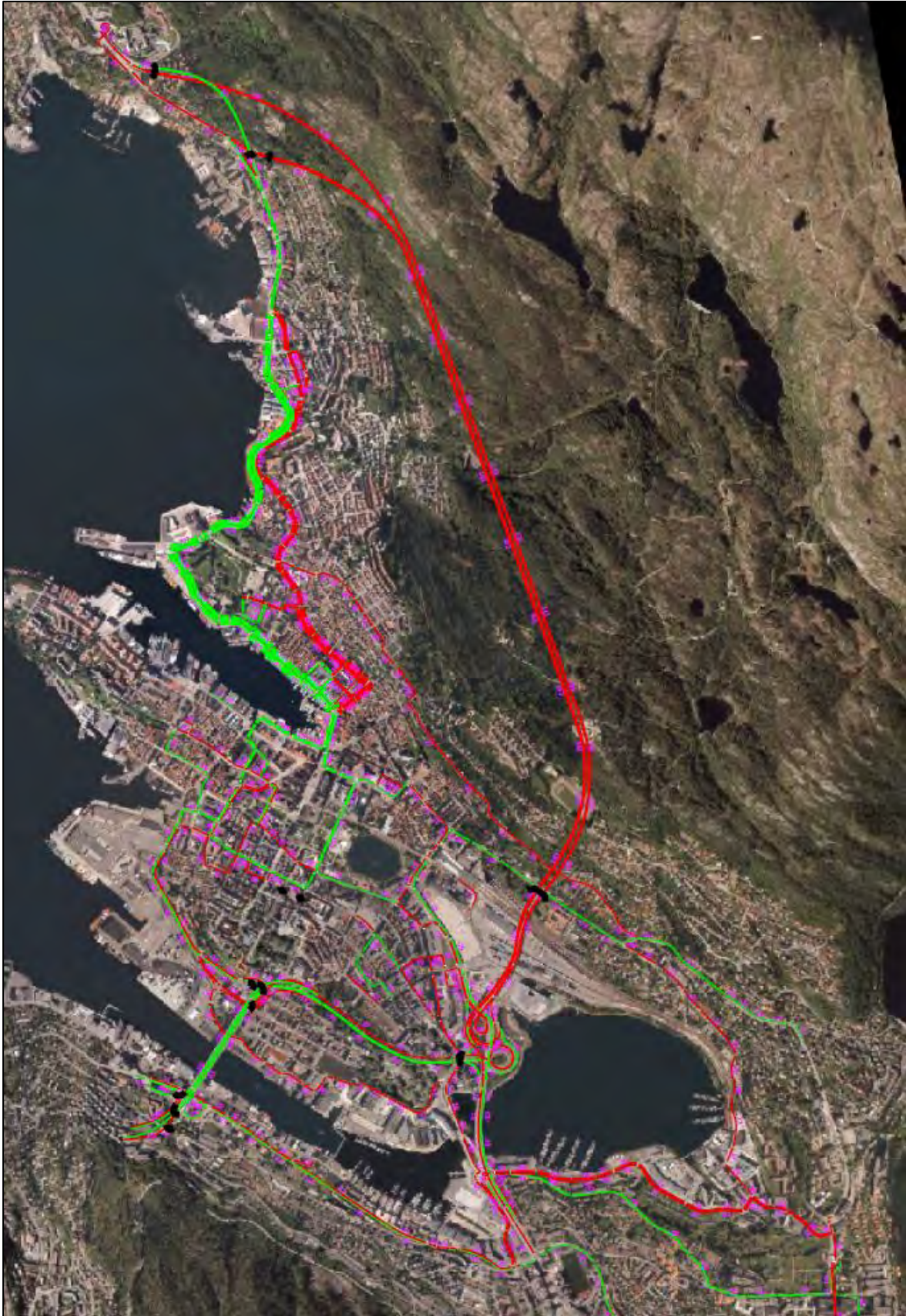
Figur 47: Differanseplot før og etter stenging av Bryggen. Rød indikerer økning i trafikk som følge av stenging, og grønn indikerer trafikkreduksjon. (kun forskjeller \pm 20 kjøretøy er vist).
